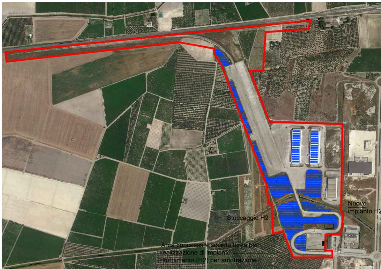
Il progetto “Il Futuro dell’Interporto di Cerignola nel solco dell’H2” prevede la costruzione di un impianto di produzione, compressione e stoccaggio dell’idrogeno realizzato in una parte dell’area industriale dismessa localizzata nell’ex Interporto di Cerignola.
