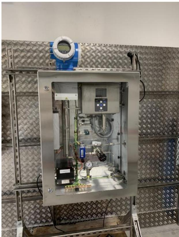
Soluzione per misurare e controllare la presenza di impurità nell'Idrogeno
